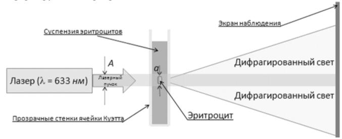
Рис.1. Схема лазерного эктациометра эритроцитов
