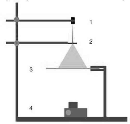
Рис.1. Схема установки для лазерной дифрактометрии мазка крови. Установка включает в себя лазер (1), мазок крови (2), экран для наблюдения дифракционной картины (3), видеокамеру (4).
