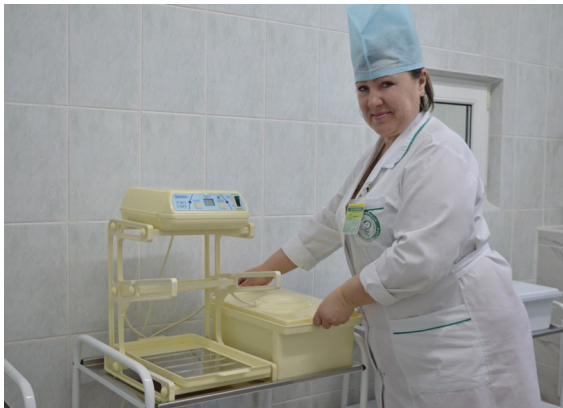
На фотографии установка для ультразвуковой очистки медицинских инструментов со световой и звуковой индикацией процесса УЗО «Меддел». Медицинская сестра ЦСО – Е.Э. Ненахова
